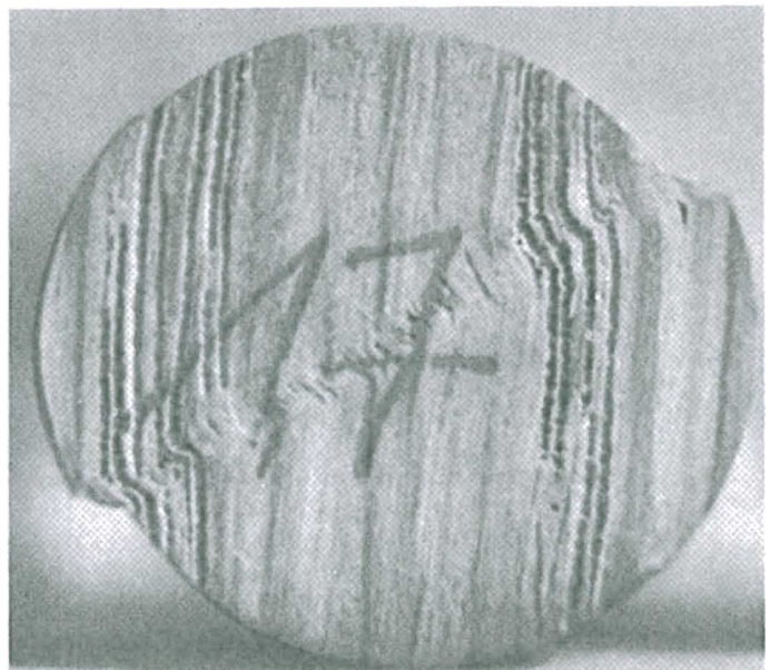
Bild 2. Bruchbilder. a - typischer Bruch der Quader, 20 mm x 20 mm x 30 mm, nach TGL 25 106 (Holzart: Buche); b - typischer Bruch der Bohrkerne parallel zur Faser, Durchmesser 15 mm (Holzart: Eiche)
